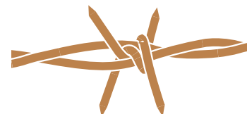
Bouclage type IOWA Bouclage entrelacé dans le cordon
