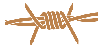
Bouclage type MOTTO Bouclage enroulé autour du cordon
