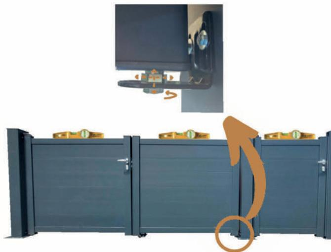
8. Positionnez le sabot au pied du vantail fixe et vissez-le dans le sol à l'aide de goujons d'ancrage M10 x Lg 90 mm (non fournis).
